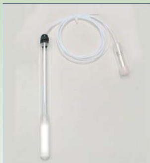
Slika 8. Usisne čašice Eijkelkamp Soil water sampler Ø 20 mm za sakupljanje uzoraka vode za potrebe kemijskih i izotopnih analiza
