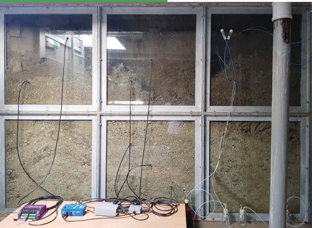
Slika 6. Mjerni uređaji ugrađeni u istočni zid istraživačkog okna (TRIME PICO 64 sonde i usisne čašice)
